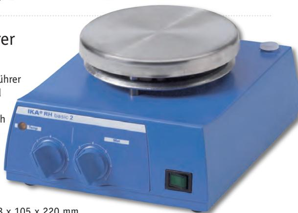
**Technische Daten:** Rührstellenanzahl 1, Rührmenge max. pro Rührstelle (H<sub>2</sub>O) 10 l, Motorleistung Abgabe 2 W, Einstellmöglichkeit Drehzahl Skala 0–6, Drehzahlbereich 100–2000 rpm, Heizleistung 400 W, Heiztemperaturbereich Raumtemp. –320 °C, Einstellmöglichkeit Heiztemperatur Skala 1–6, Sicherheitskreis fest 400 °C, zulässiger Umgebungstemperaturbereich 5–40 °C, Spannung 220–240 / 115 / 100 V, Frequenz 50/60 Hz, Geräteaufnahmeleistung 415 W
